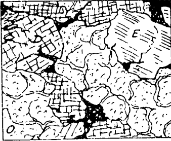
شكل ٥٨ — ليهرزوليت: D، ديوبسيد: O، أوليفين: E، أنستاتيت؛ بالأسود، أكسيد الحديد الأولي.
