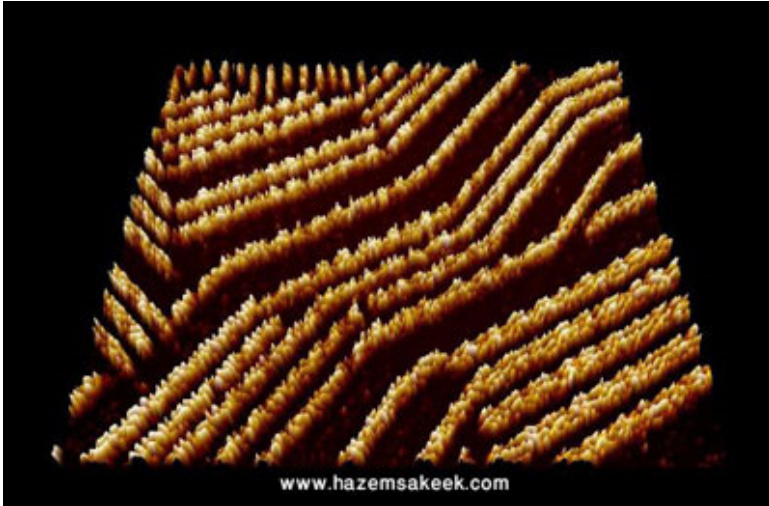
صورة STM لسلسلة جزئيات تجمعت بشكل ذاتي لشبه موصل عضوي على الجرافيت
