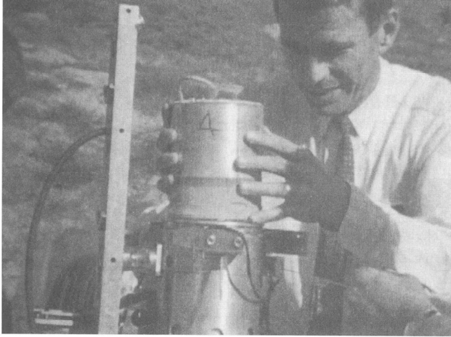
إد داي يضع العلبة رقم 4 الحاوية على 2,3 رطلاً من المادة المتفجرة سي فور في مكانها في كدسة قذف الشحنة داخل النموذج بطول متر واحد.
