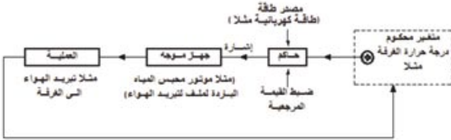
شكل ٩-١ مكونات دائرة التحكم
