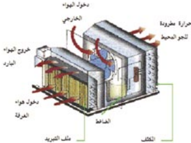
شكل ٧-٣ رسم تخطيطي لوحدة تكييف شبك
