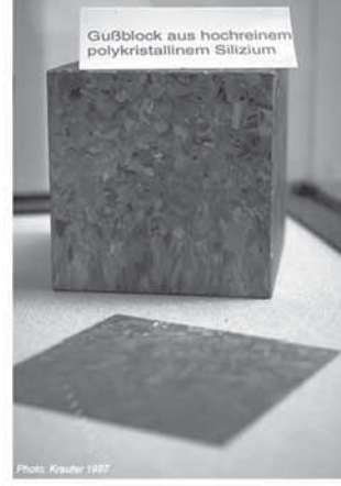
الشكل (6-2): قالب سيليكوني متعدد البلورة بمقطع عرضي على شكل مربع.
